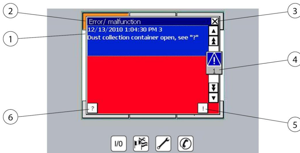
Fig. 40: Dust collection container error message
